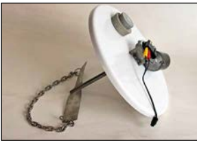
Deckel mit Rührwerk. Mit dieser Technik lässt es sich natürlich fein arbeiten und beste Ergebnisse erzielen.
