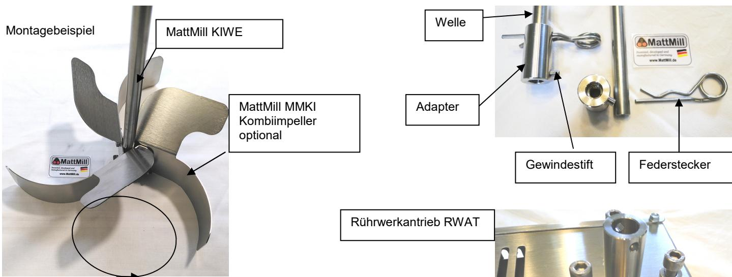
Montage: Adapter mit dem M8 Innengewinde fest auf die M8 Motorwelle aufschrauben. Mit dem M5 Gewindestift (Inbusschlüssel 2,5mm) gegen Abdrehen sichern. Welle in den Adapter einstecken und mit dem Federstecker sichern. Drehrichtung des Antriebs ist gegen den Uhrzeigersinn.
