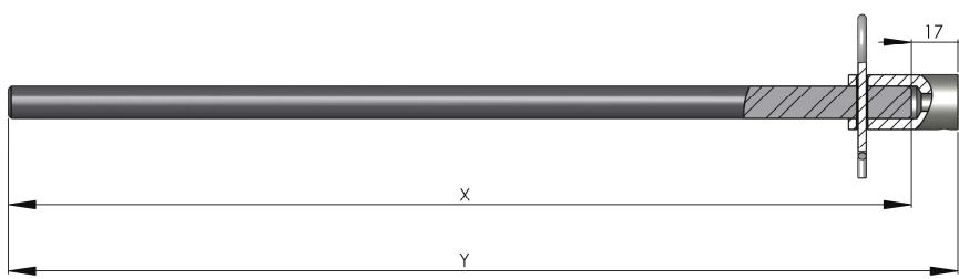
Die Kombiimpellerwelle KIWE EK (X=280mm) ist in Verbindung mit dem MattMill Kombiimpeller MMKI für gebräuchliche Einkocher oder Behälter mit ca. 28-30cm Tiefe passend.
