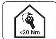
EXTERNE ANSCHLUSSTEILE DÜRFEN NUR MIT EINEM MAXIMALEN DREHMOMENT VON 20 Nm ANGEZOGEN WERDEN
